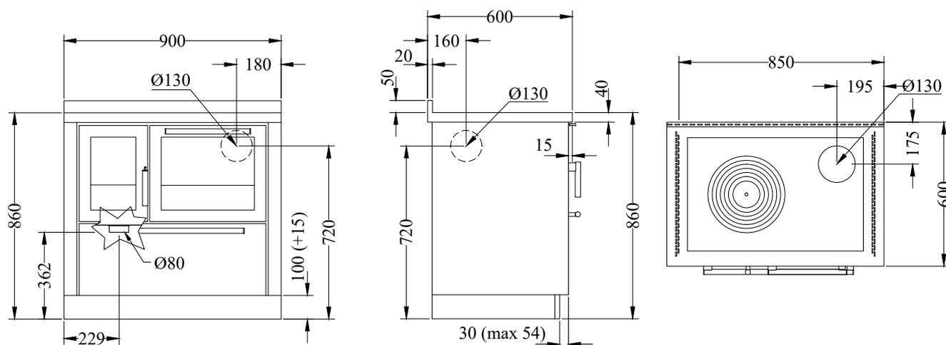
Version avec sortie de fumées à droite. La version avec sortie de fumées à gauche est symétrique.
