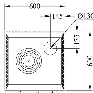
Version avec sortie de fumées à droite. La version avec sortie de fumées à gauche est symétrique
