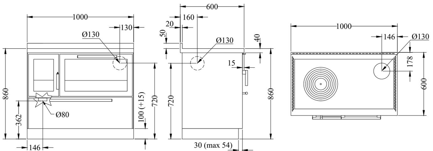
Version avec sortie de fumées à droite. La version avec sortie de fumées à gauche est symétrique.
